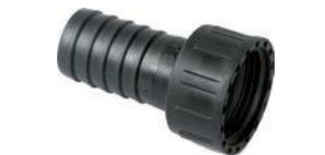
PORTAGOMMA DIRITTO F in PP ghiera mobile, guarnizione in EPDM
